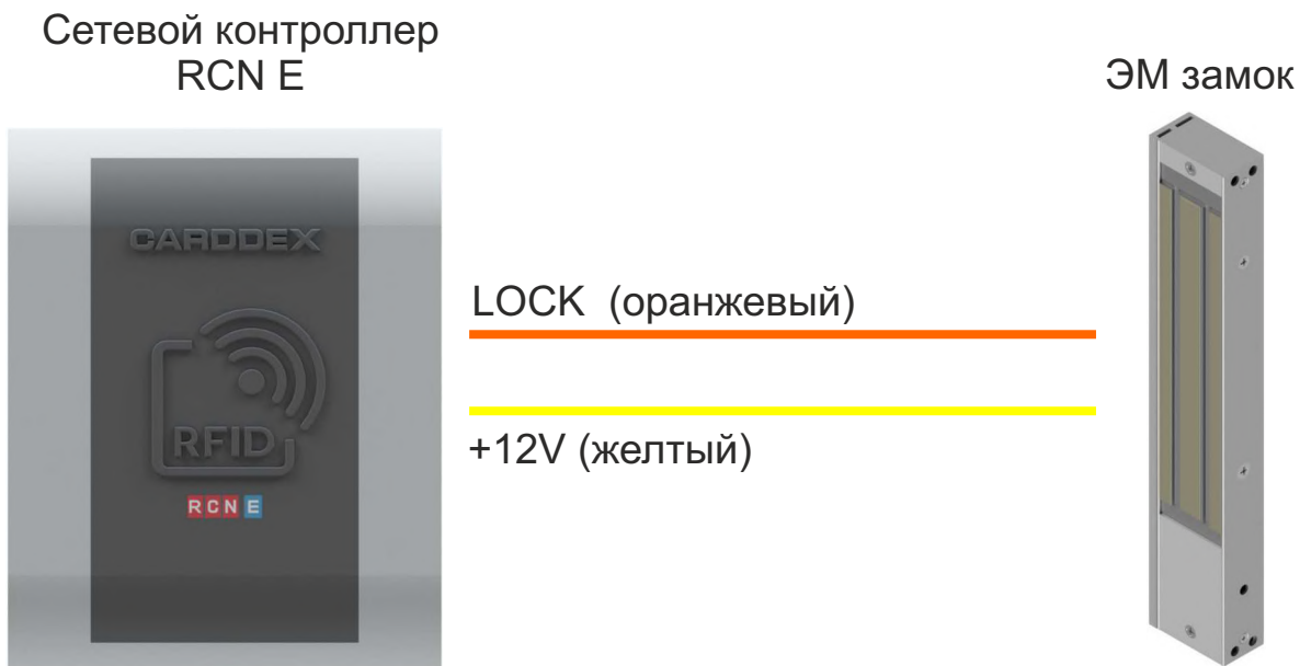
Рисунок 4.4 Подключение запирающего устройства
